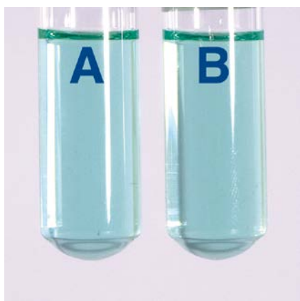
2 kyvety (A / B) se stejnou koncentrací ChSK
